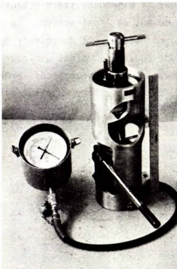
Fig 11 - Appareil d'essai de poinçonnement pour déterminer la résistance des roches à la compression uniaxiale.
