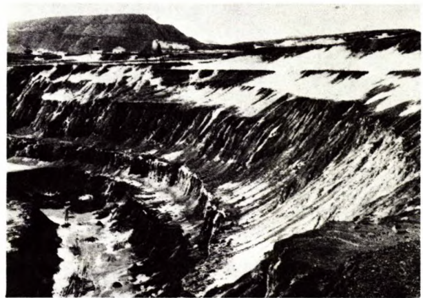
Fig 22 - Exemples de variabilité de la paroi d'une mine: un glissement sur une paroi dans une section de la mine qui ne semblait pas différente des autres où il n'y a pas eu de glissement. En d'autres termes, le glissement était impossible à prédire avec certitude.
