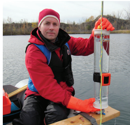
Bouteille de prélèvement Kemmerer utilisée pour recueillir des échantillons d'eau en profondeur dans les fosses minières inondées.
