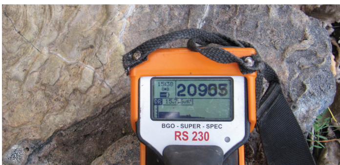
Spectromètre gamma portatif utilisé pour mesurer la radioactivité des déchets miniers.
