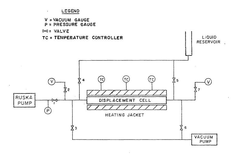
. displacement apparatus Experimental 4 : Figure
