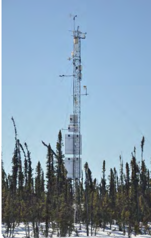
Des instruments alimentés par pile solaire sur la tour de Scotty Creek, aux Territoires du Nord-Ouest, prélèvent des données sur les gaz à effet de serre et les flux d'énergie.
