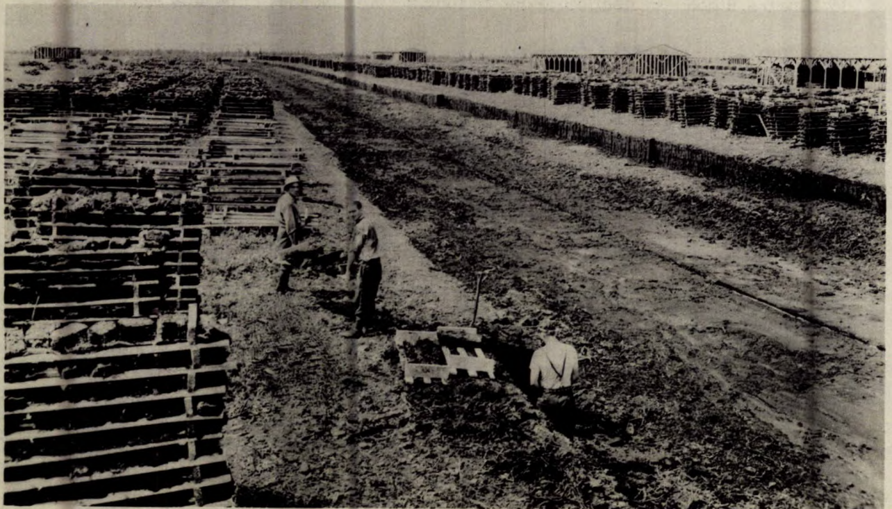
Figure 7 - Séchage de la tourbe sur des clais.
