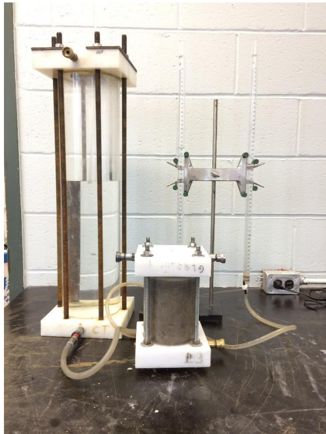
FIGURE 3. ÉQUIPEMENT UTILISÉ POUR LES ESSAIS DE PERMEABILITÉ EN COLONNE.
