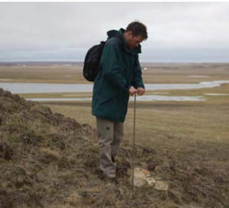
Un employé de Parcs Canada utilise une sonde pour mesurer la profondeur de la couche active au parc national du Canada Aulavik.
