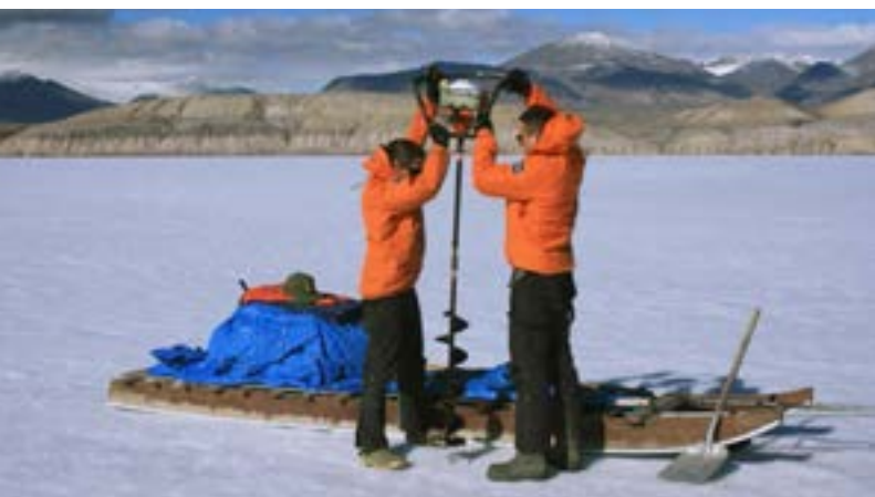
Des employés de Parcs Canada utilisent une tarière pour mesurer l'épaisseur de la glace au Lake Hazen, dans le parc national du Canada Quttinirpaq.
