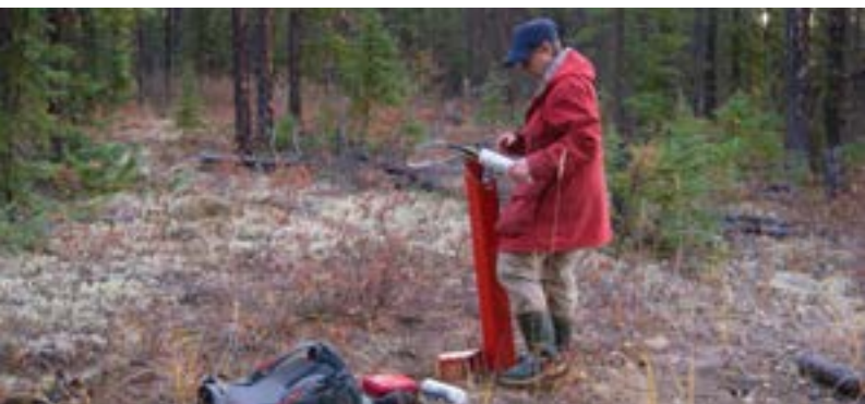
Sharon Smith change un enregistreur de données à un site de surveillance du pergélisol au sud de Fort Simpson, dans les Territoires du Nord-Ouest.
