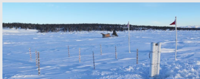
FIGURE 19 : Station communautaire de surveillance de la glace de Nain, à Terre-Neuve-et-Labrador, où l'on peut voir un prototype de capteur SmartICE pris dans la glace (avant-plan droit). Le capteur envoie des mesures quotidiennes de l'épaisseur de la glace par satellite au portail de données SmartICE. Photo gracieuseté de R. Briggs.
