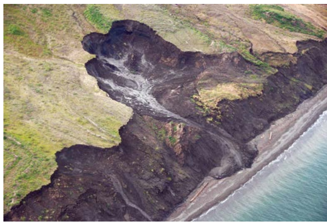
FIGURE 5 : Photographie aérienne d'un glissement régressif dû au dégel le long de la côte de la mer de Beaufort, au Yukon, produit par le dégel de sédiments à haute teneur en glace. Photo gracieuse et de N.J. Couture.
