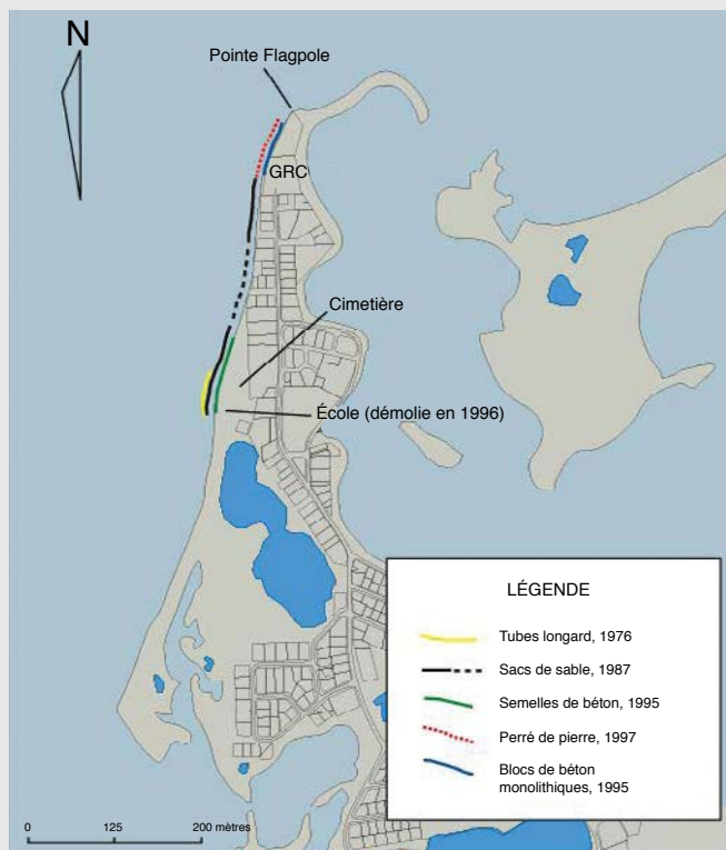
FIGURE 22 : Emplacement de diverses mesures de protection du littoral installées à Tuktoyaktuk en vue d'aider à contrôler l'érosion et les inondations (tiré de Couture et al. , 2002).
