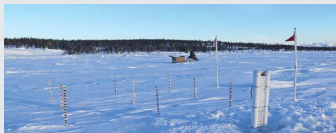
FIGURE 19 : Station communautaire de surveillance de la glace de Nain, à Terre-Neuve-et-Labrador, où l'on peut voir un prototype de capteur SmartICE pris dans la glace (avant-plan droit). Le capteur envoie des mesures quotidiennes de l'épaisseur de la glace par satellite au portail de données SmartICE. Photo gracieuseté de R. Briggs.
