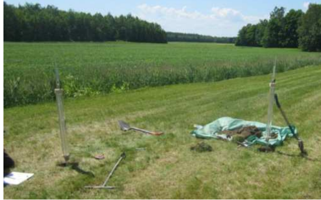
Figure 25. Perméamètres de Guelph installés sur le terrain
