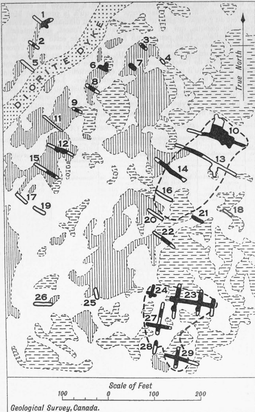
Figure 3. Plan du groupe de gites miniers numéro 2, mine Amulet, montrant les excavations (nos 1 à 29). Le minerai est représenté par le noir foncé; les affleurements et les étendues à jour de dalmatianite par des verticales; l'andésite par des lignes horizontales brisées; le dyke de diorite par le pointillé et le contour horizontal de l'amas de minerai par des traits noir foncé.
