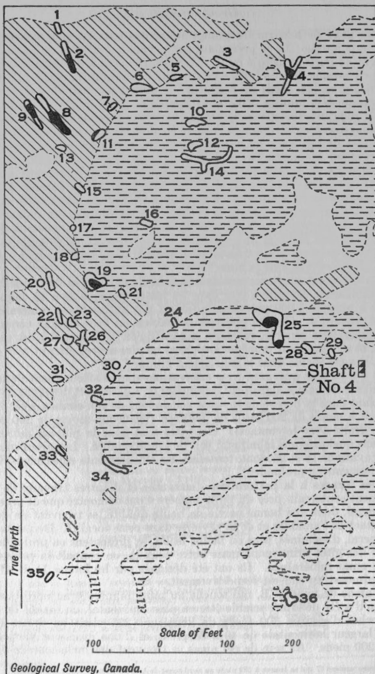
Figure 4. Plan de la partie à découvert du groupe de gîtes miniers numéro 4, mine Amulet, montrant les excavations (nos 1 à 36). Le minerai est représenté par le noir foncé; les affleurements et les étendues à jour d'andésite par des lignes horizontales brisées, et la rhyolite et la brèche de rhyolite (en partie altérée en dalmatienne) par des diagonales.
