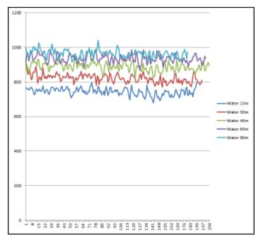
FIGURE 22 COUNT RATE TIME SERIES OVER THE WATER LINE FOR THE NRCAN SYSTEM. THE X AXIS SHOWS THE TIME ALONG THE SURVEY LINE IN SECONDS.
