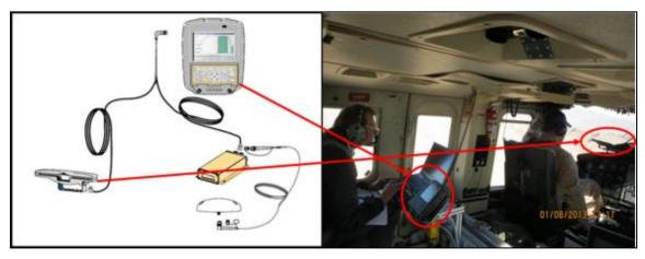
FIGURE 8 TRIMBLE STEERING SYSTEM IN USE DURING AMS FLIGHT.
