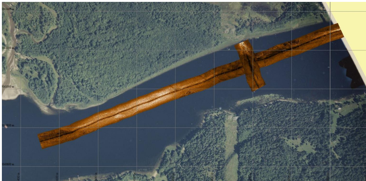
Figure 21. Résultat du traitement des données sonar pour une ligne de relevé dans le sens du courant (ligne 73) et une ligne de relevé en travers du courant (ligne 81) superposées à une photographie aérienne.
