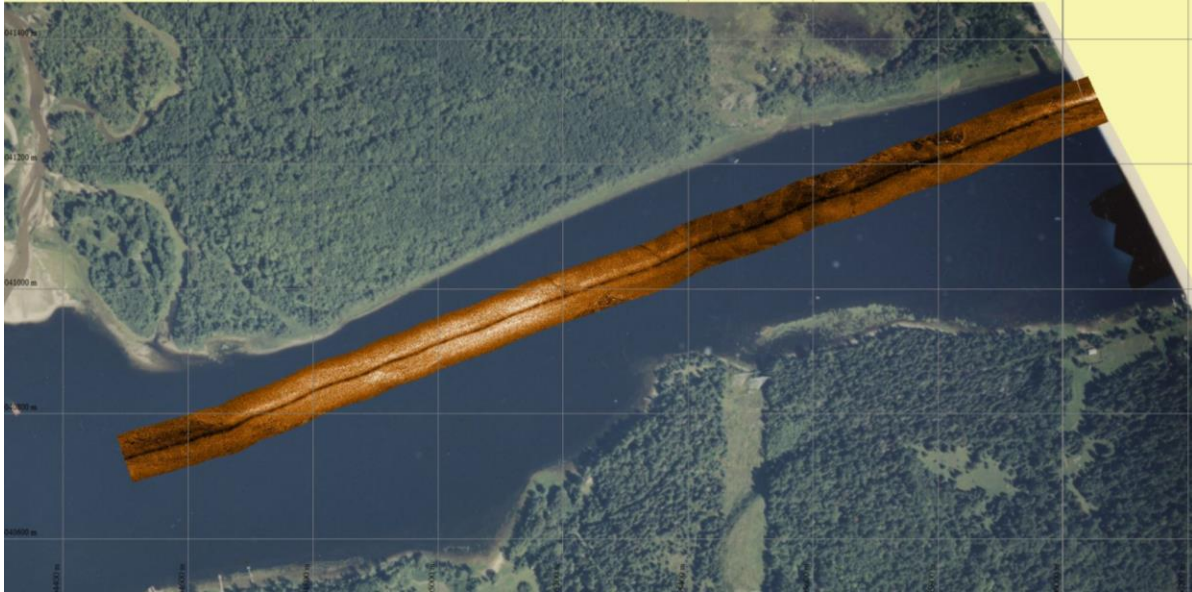
Figure 20. Résultat du traitement des données sonar pour une ligne de relevé (ligne 73) superposée à une photographie aérienne.
