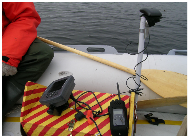
Vue rapprochée de l'équipement de levé bathymétrique.
