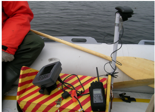
Vue rapprochée de l'équipement de levé bathymétrique.
