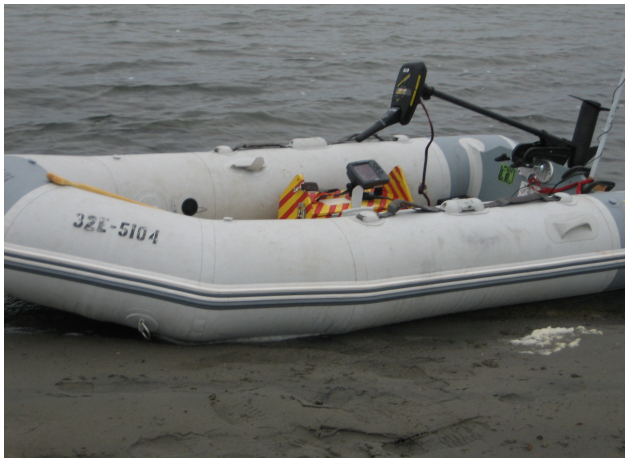
Équipement utilisé pour acquérir les données bathymétriques: échosondeur de pêcheur et récepteur GPS.
