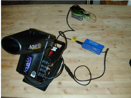
Caméra sous-marine de pêcheur utilisée pour observer le lac Geraldine
