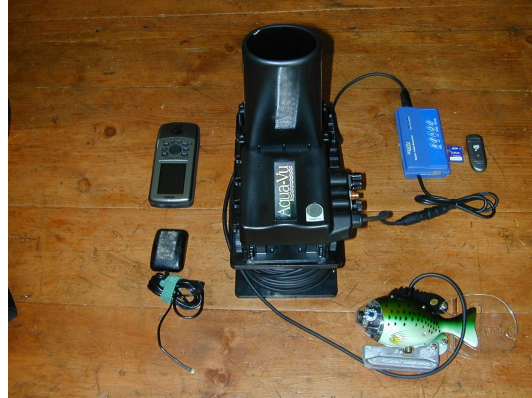
Caméra sous-marine de pêcheur utilisée pour observer le lac Geraldine
