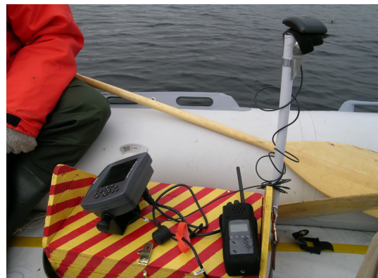
Équipement utilisé pour la collecte des données bathymétriques : Sonar couplé à un GPS.
