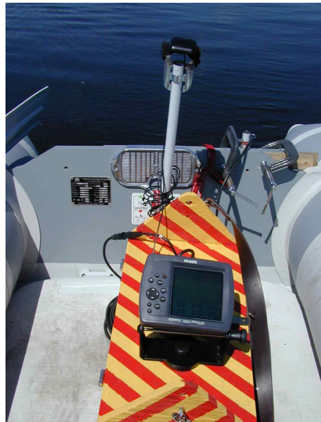
Vue rapprochée du récepteur GPS et de l'échosondeur de pêcheur.
