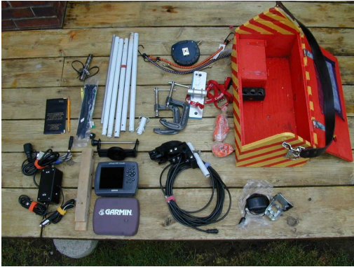
Équipement de relevé bathymétrique: Robuste, facile à utiliser, et peu dispendieux.
