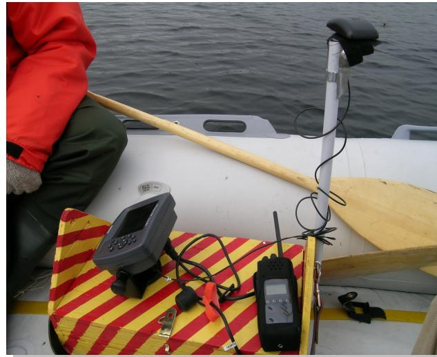
Vue rapprochée du récepteur GPS et de l'échosondeur de pêcheur.
