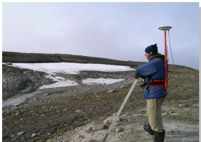
Validation de la limite d'un bassin versant en marchant le long de la ligne de partage des eaux.
