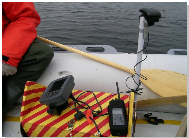
Vue rapprochée du récepteur GPS et de l'échosondeur de pêcheur.
