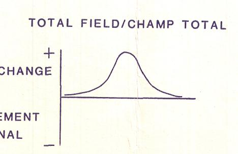
RESPONSE TO A CONDUCTOR / RÉPONSE À UN CONDUCTEUR
