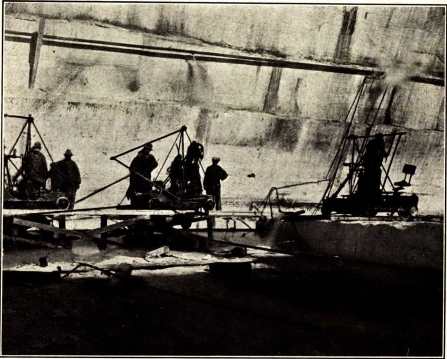
Marbre de Missisquoi. Trancheuses dans la carrière de la Missisquoi-Lautz Corporation, Phillipsburg, Qué.
