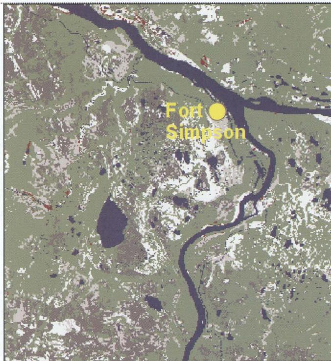
*Modèle thermique illustrant la présence du pergélisol sous les conditions actuelles de température moyenne annuelle de l'air de  $-4^{\circ}\text{C}$ , Fort Simpson, T.N.-O. Les zones blanches indiquent la présence du pergélisol.*
