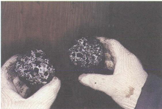
*Échantillons de carotte montrant des hydrates de gaz visibles.*
