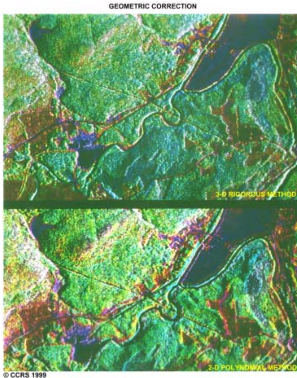
Figure 1 : Sous-ortho-images en couleur composée RAS ouest/SPOT-PLA/RAS est (4 x 3 km; pixel de 5 m) avec superposition du fichier vectoriel des routes, par la méthode polynomiale (en bas) et par la méthode photogrammétrique (en haut).
