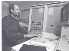
Analyse isotopique au moyen d'un spectromètre de masse à source solide
