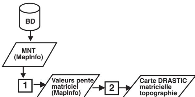
**Figure 9.** Organigramme de l'élaboration de la carte du paramètre «topographie» pour la méthode DRASTIC. [1] Transformation de la taille des pixels, de 30 m sur 30 m à 500 m sur 500 m. [2] Obtention des valeurs de pente à partir du modèle numérique de terrain (MNT). [3] Classification des pixels en fonction de la méthode DRASTIC.
