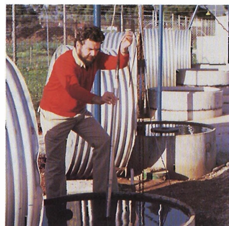
Figure 14 Patrick Killeen étalonnant une sonde de rayons gamma normalisée de la CGC, à Adelaide, Australie, dans le cadre d'un projet d'interétalonnage international visant à normaliser tous les modèles d'étalonnage dans le monde.
