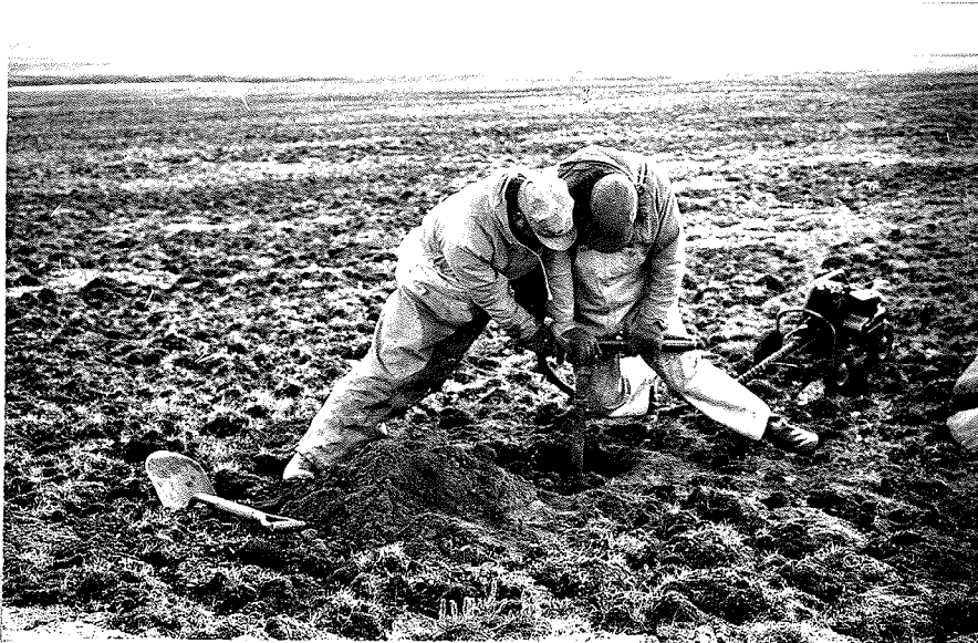
Photographie 3: Foreuse Haynes actionnant un carottier modifié du type CRREL. La pression exercée par les foreurs contrôle la vitesse de pénétration à l'intérieur du pergélisol. Le système est facilement transportable. (Cliché no 167853 de la Commission géologique du Canada).
