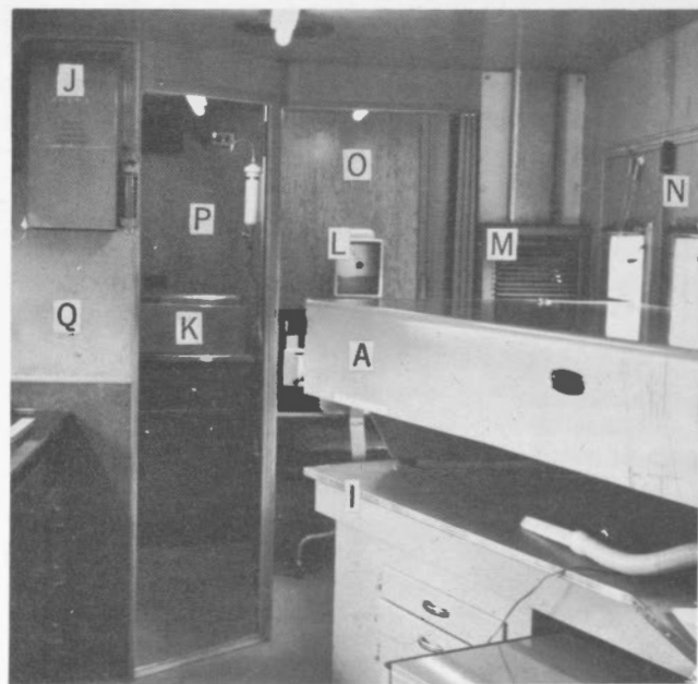
Planche LXVII B. Chambre de spectrographie, vue de fond de la roulotte. A — spectrographe, I — support de spectrographe portatif, J — ventilateur, K — bain révélateur, L — densimètre, M — aérotherme à gaz, N — porte à deux battants, O — chambre du densimètre, P — chambre noire, Q — chambre du spectrographe.
