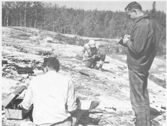
Planche LX B. Levé sismique au marteau. La plupart des points de frappe sont plus éloignés de la station d'enregistrement. P. J. Hood 121899
