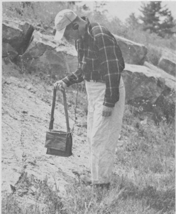
A. Utilisation d'un détecteur avec écouteurs pour évaluer un affleurement.
