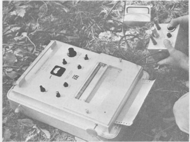
Planche LX A. Sismographe portatif (photo de Gilbert A. Milne and Co. Ltd.).
