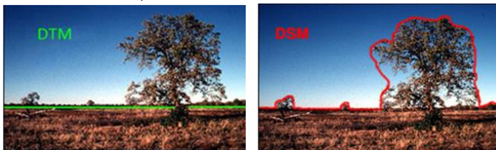
Figure2 : Représentations de MNT (DTM) et MNS (DSM) (source : Wikipédia)
